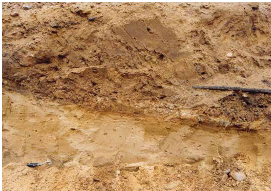
Afbeelding 4: donkerbruine stenenrijke keileem liggend op onverstoorde zandige fluvioglaciale afzettingen. De begrenzing tussen de twee eenheden is scherp. Locatie zuidoosthoek van de Zanderij Crailoo, langs de weg naar de Sportvallei. Foto: Sander Koopman.
